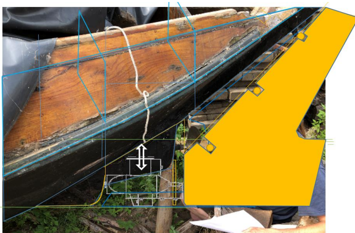
Nieuw roer ontwerp ter verbetering van roer werking, ook is getoond nieuwe POD, zie elektrische voorstuwing
