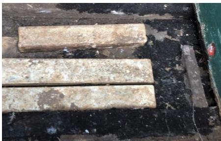
Lood broodjes (momenteel) aangebracht tussen houten balkjes die op het vlak zijn geschroefd/gespijkerd, deze balkjes moeten voorkomen worden.
