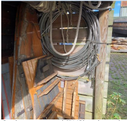
Opslag van staand (RVS) en lopend wand
