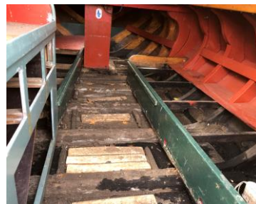
Lood broodjes (momenteel) aangebracht tussen houten balkjes die op het vlak zijn geschroefd/gespijkerd, deze balkjes moeten voorkomen worden.
