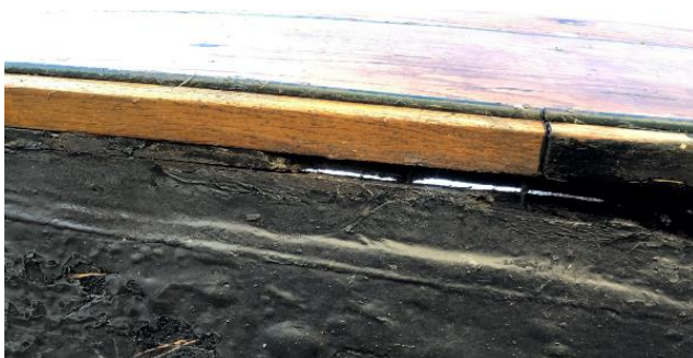
Berghout met doorgerotte huid aan ter plaatse van onderzijde van berghout
