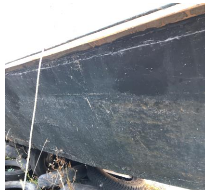
Berghout met doorgerotte huid aan ter plaatse van onderzijde van berghout
