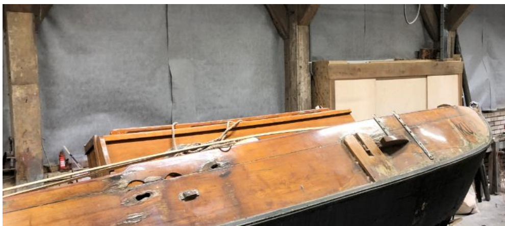
Aanpassing nodig van afwateringsgaten op van water op dek en de zwaardophanging
