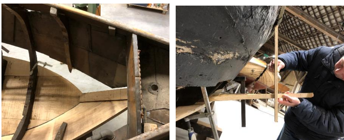
Locatie van de bun voor de toekomstige POD-drive (links) en eerste afmetingen (rechts)
