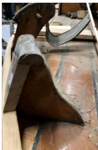
Muis-hol op dek spant/bolder ontbreekt waardoor houtrot in dek en in bolder/steun is ontstaan. Muis-hol van voldoende grootte toepassen om water goed naar achterschip door te laten.
