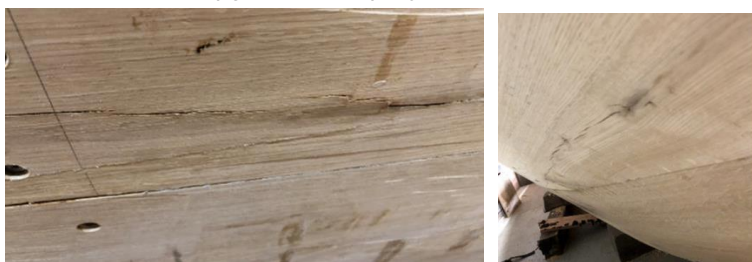
Scheuren door of na verbuigen van hout
