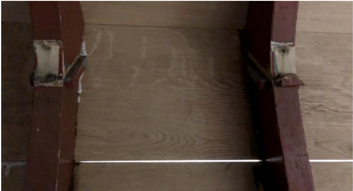
Zijkanten die nog niet zijn gebreeuwd.
