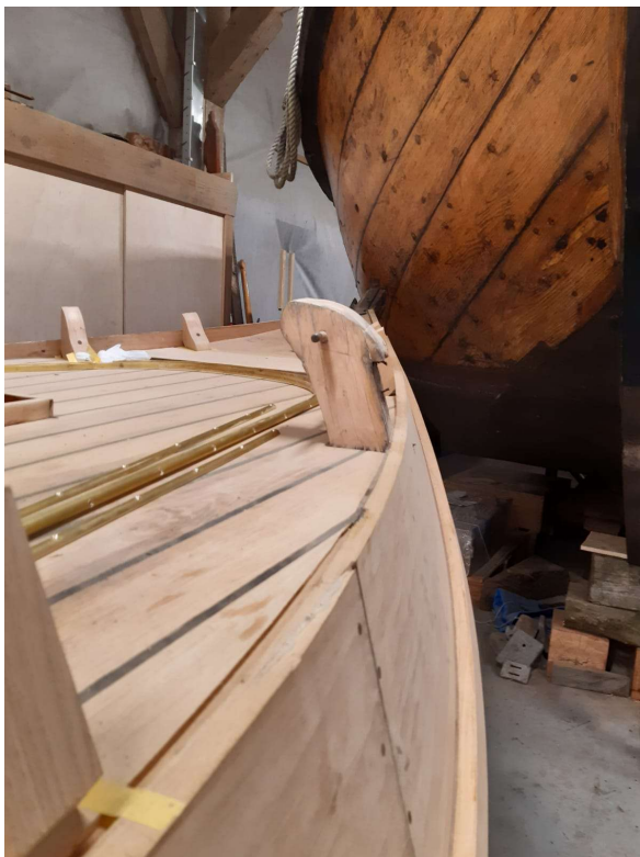
Messing lijst (als toegepast op KU12) vastzetten met kit tegen inwateren
