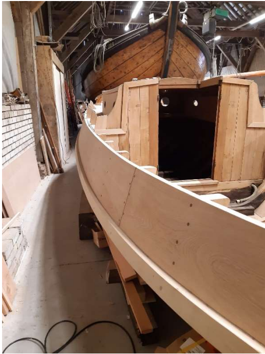
Achterzijde kajuit is geschuurd en sierlatten vervangen
