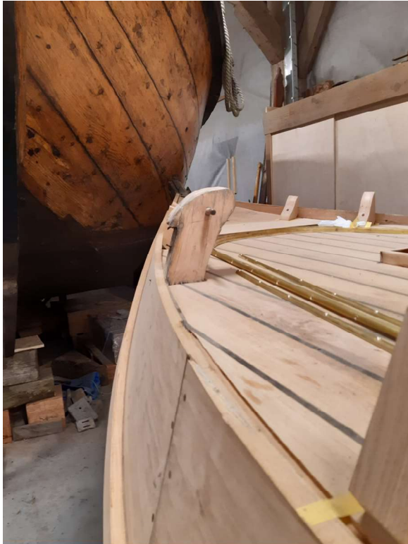
Aan voorzijde van bolder dek verdikken voor afwateren en er geen water achter kan blijven staan. Dek verdikking aanbrengen zodat er geen water onder kan blijven staan.
