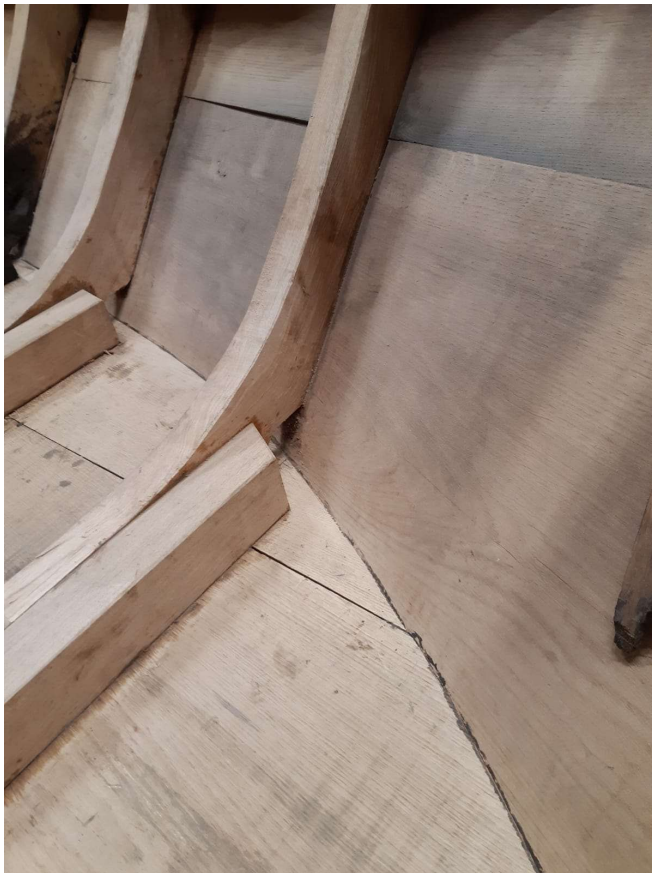
Spaargaten in spanten zijn voldoende groot om onderhoud te kunnen plegen (in olie zetten)
