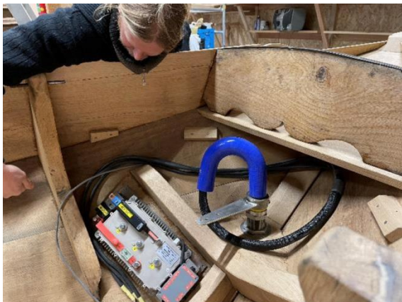
Kabel tussen POD en controller
