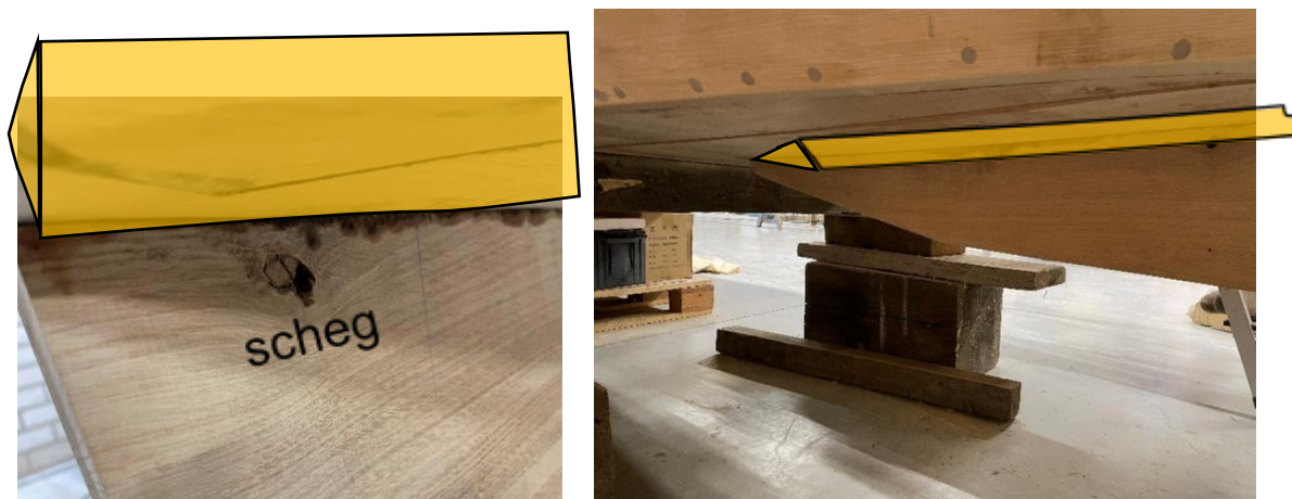
Schegversterking tussen romp-scheg
