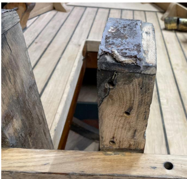
Scheuren in bovenzijde mast-steun
