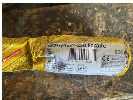
Butyl kit gebruikt als flexibele naad vulling in de KU12
