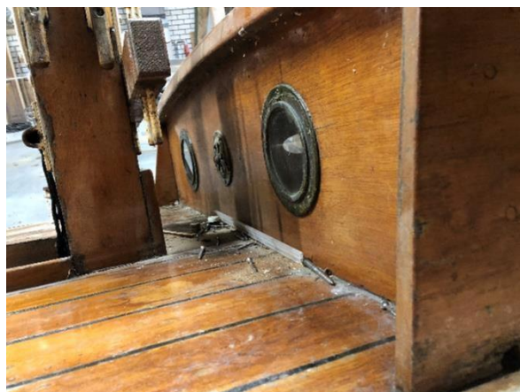
Muis-hol van opbouw aan voorzijde is te klein om goed te kunnen lakken.
