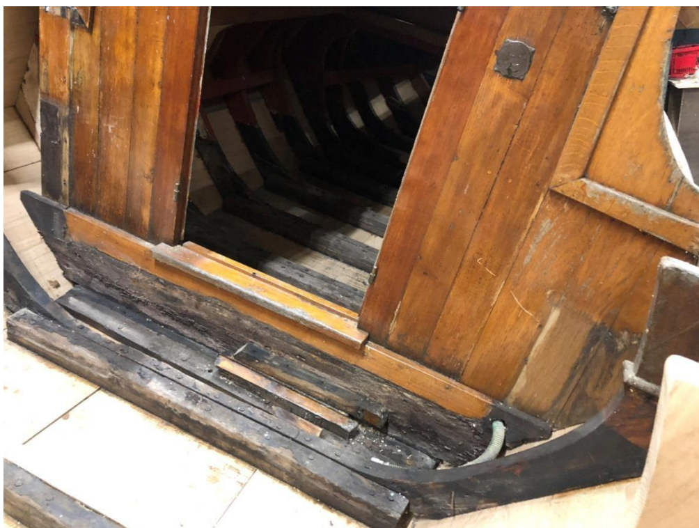
Balk onder de ingang van kajuit heeft (nog) geen muis-hol
